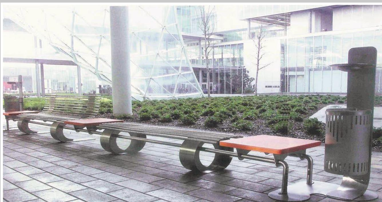
La struttura portante è costituita da lamine J curvate e rinforzate con lamine perpendicolari a forma di mezzaluna disposte internamente alla curvatura principale. La sagomatura permette di formare sedute con o senza schienale, di inserire i piani di appoggio e cestini. Può essere realizzato in acciaio inox Aisi 304L, oppure in ferro con trattamento di zincatura a caldo in bagno per elemento completo già finito e finitura con verniciatura a polveri previo trattamento con apposito primer.
